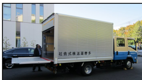
写真6 添乗教育を実施する訓練車。テールゲートリフターも架装している。
