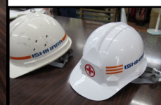
写真3 保護帽（墜落時保護用）側面に通気孔型を明記
